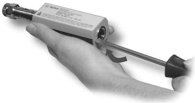
Figura 12 Rimozione dell'housing del sensore di potenza
